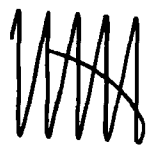
Abb. 5. Oscillogramm des Wechselstroms für Leitfähigkeitsmessungen.
